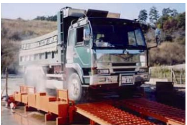
図 2.5 スパッツによる洗浄イメージ
