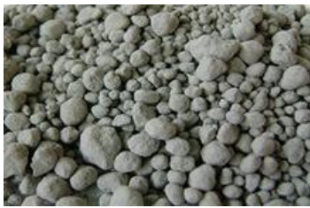
図 2.17 焼却灰の造粒固化による造粒物
