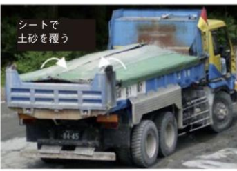
図 2.6 飛散防止シートイメージ
