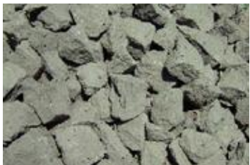
図 2.15 混練り固化による再生砕石
